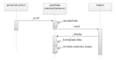
**Figure 9-4.** *HTC* <pro:inputDate> scroll() *function*
